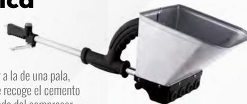
Su utilización es similar a la de una pala, de forma muy simple se recoge el cemento con la tolva y con la ayuda del compresor de aire, el mismo es "expulsado" a través de las ranuras inferiores sobre la superficie a rellenar, realizando movimientos verticales de forma muy sencilla.
